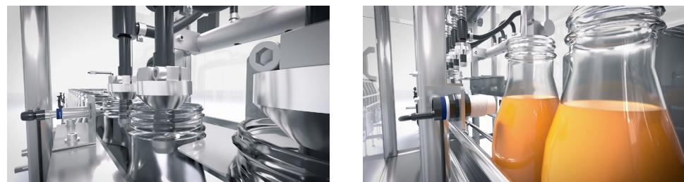
In sintesi, un OEM nel segmento degli imballaggi trae vantaggio dall'utilizzo di sensori IO-Link con soppressione dello sfondo per il rilevamento delle bottiglie, consentendo una produzione accurata ed efficiente, un monitoraggio dei dati in tempo reale e una manutenzione e sostituzione semplificate dei sensori. Questa tecnologia migliora le prestazioni dei macchinari per l'imballaggio, portando a una maggiore soddisfazione dei clienti e a risparmi sui costi.
